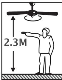
Definire la posizione da destinare all'apparecchio considerando l'ingombro delle pale rotanti. Utilizzando 2 viti con tasselli per muro (**NON IN DOTAZIONE**) di adeguata robustezza al peso dell'apparecchio, fissare sul soffitto l'attacco **A**.
